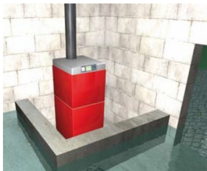
protection par disposition étanche
