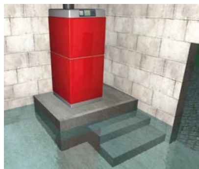
Mise hors d'eau par surélévation
